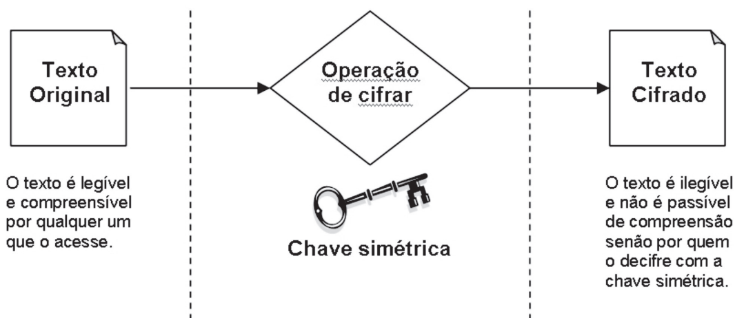
Fig. 1. Simplificação da operação de cifração por algoritmo simétrico
