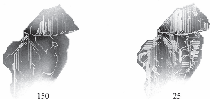
Figura 17 - Fluxos acumulados extraídos do grafo de fluxos locais a partir do modelo DEM. O número associado a cada figura indica o valor de corte do fluxo acumulado
